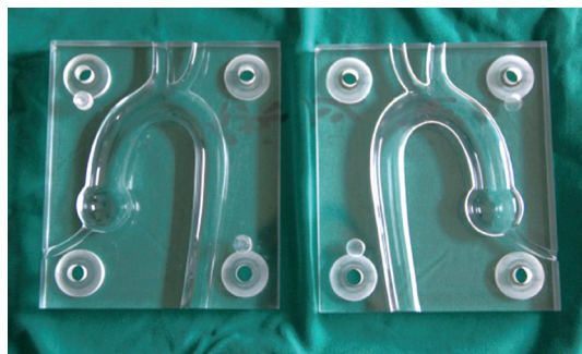
图 1 犬胸主动脉模拟释放装置实物图
